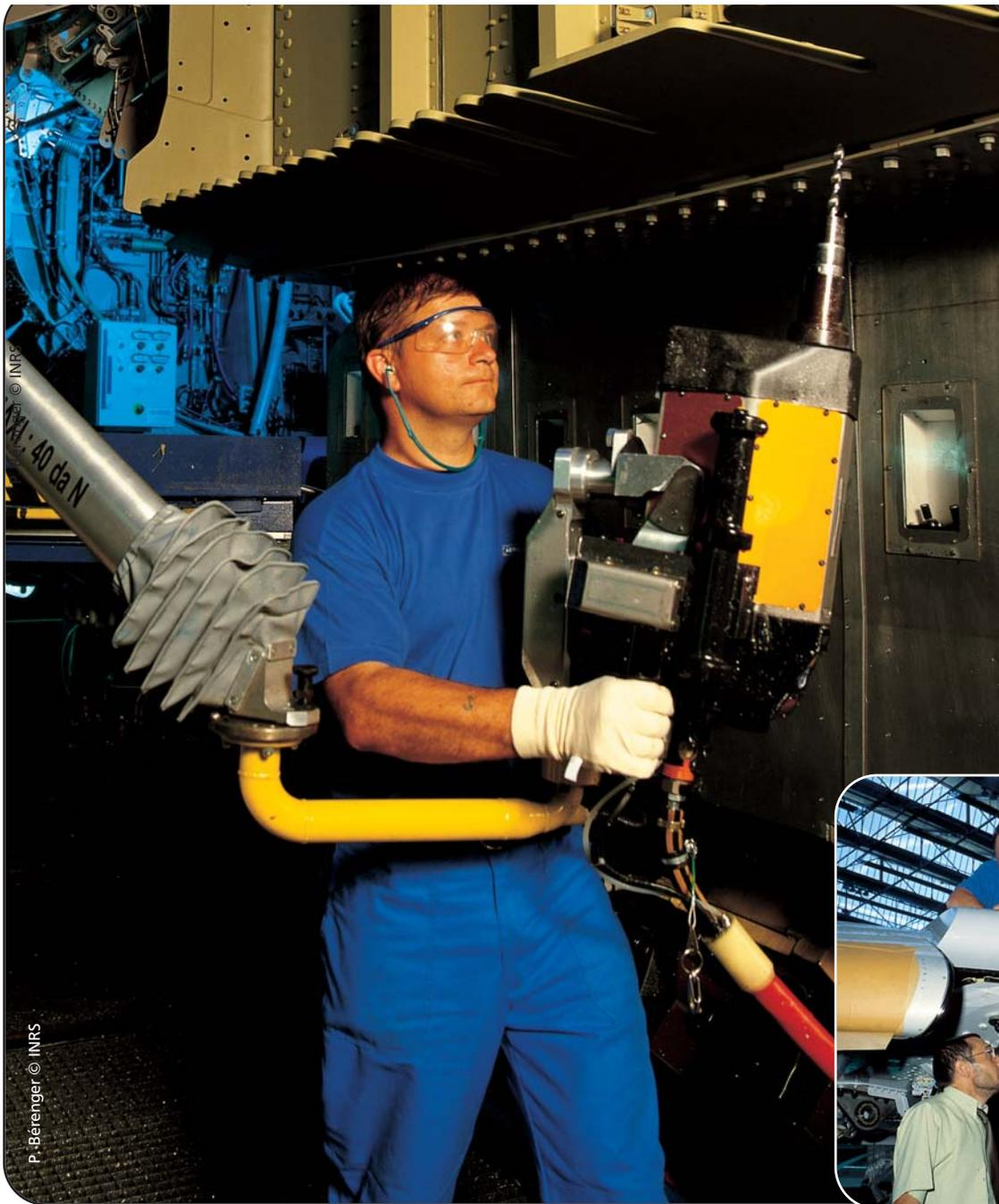
Aux postes où s'effectue la jonction du fuselage et de la voilure, l'analyse des risques a contribué à la mise en place d'un "bras manipulateur" d'aide à la manipulation des unités de perçage-alésage.
