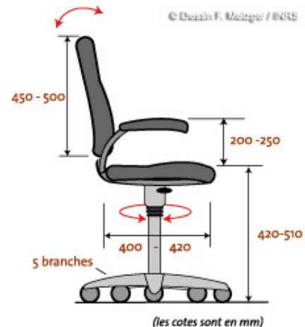
Schéma d'un fauteuil ergonomique conforme à la norme NF EN 1335-1
